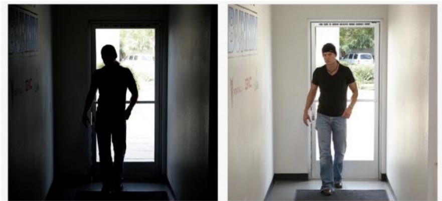
شکل ۷ بکارگیری تصحیح نور پس‌زمینه (WDR): تصویر سمت چپ بدون استفاده از WDR و تصویر سمت راست با WDR گرفته شده است.
