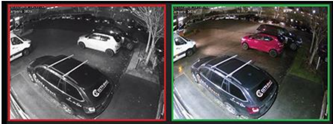
شکل ۹ بکارگیری نور ستاره (Starlight): تصویر سمت چپ بدون استفاده از Starlight و تصویر سمت راست با Starlight گرفته شده است.
